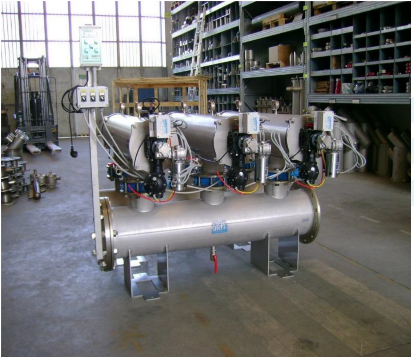
Fig. 1 Filtro autopulente per acqua industriale
